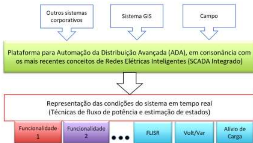
Fig 9 – Arquitetura do SCADA/ADMS
